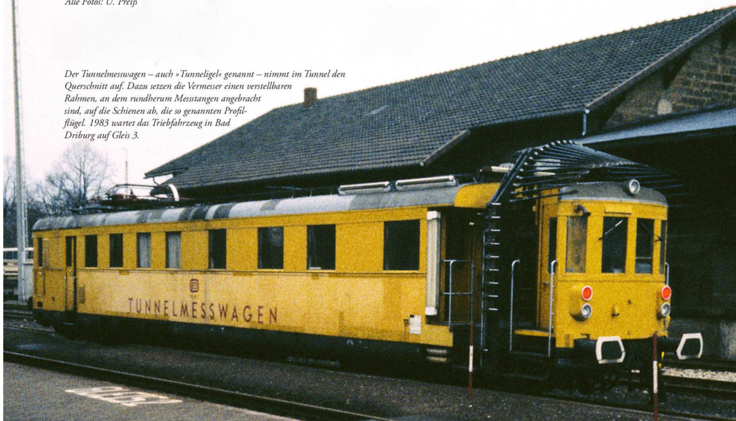
Der Tunnelmesswagen – auch »Tunneligel« genannt – nimmt im Tunnel den Querschnitt auf. Dazu setzen die Vermesser einen verstellbaren Rahmen, an dem rundherum Messstangen angebracht sind, auf die Schienen ab, die so genannten Profilflügel. 1983 wartet das Triebfahrzeug in Bad Driburg auf Gleis 3.
